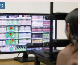
①視覚情報が姿勢などに及ぼす影響を調べるマルチチャンネル全視野刺激装置。②目の動きから被験者の興味対象や視覚情報処理の仕組みを調べる非接触型眼球運動計測装置。
